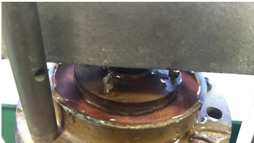
Figura 15: Problema ocorrido durante o teste de condutibilidade hidráulica mesmo diminuindo a carga hidráulica pela metade.
