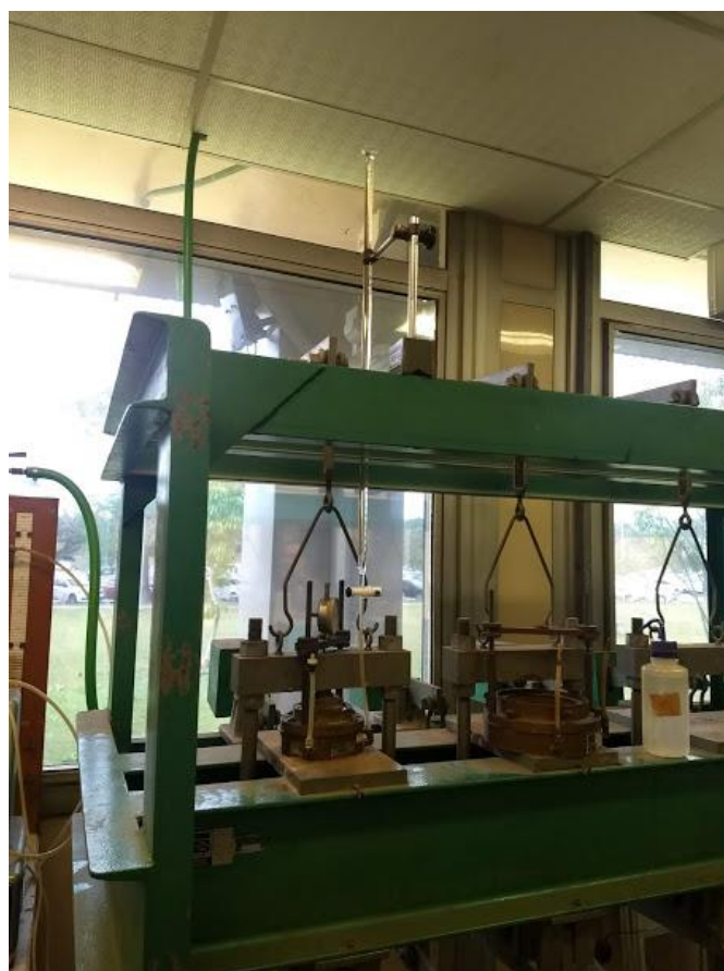
Figura 14: Apresentação da montagem do equipamento para medição de condutividade hidráulica. O corpo de prova está posicionado na parte inferior e a bureta colocada acima conectados por tubos.
